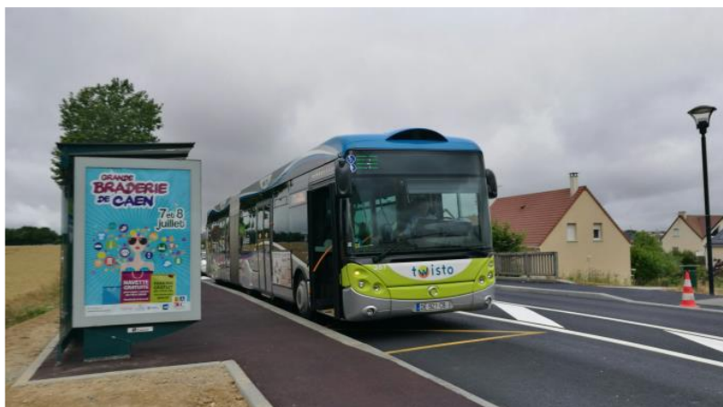
Figure 71 : Création en 2017 d'un nouvel arrêt Twisto « Festyland », sécurisé et accessible grâce à l'aménagement d'un quai de plain-pied, sur la commune de Carpiquet (Source : Caen la mer)
