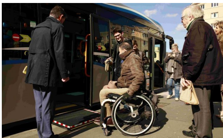
Figure 70 : Une majorité du parc de bus est aujourd'hui équipée d'une rampe d'accès électrique pour permettre aux PMR* d'accéder plus facilement au bus.
